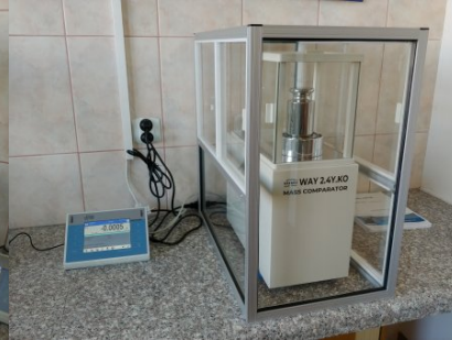
Wzorcowanie wzorców masy w Laboratorium Masy
