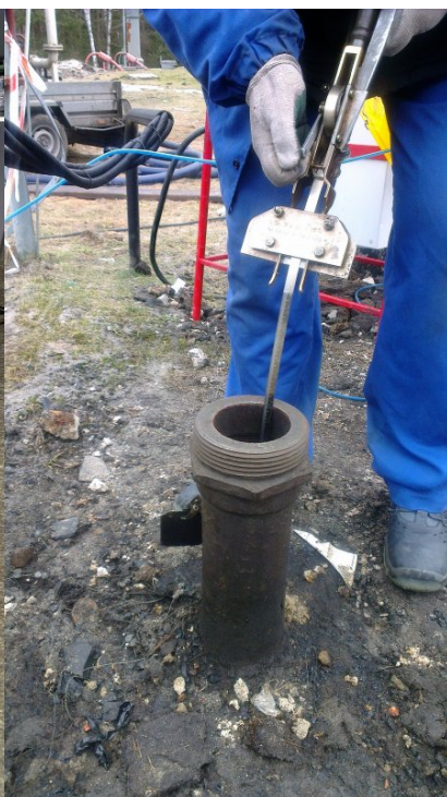
Pomiar wysokości napełnienia zbiorników za pomocą przymiaru wstęgowego
