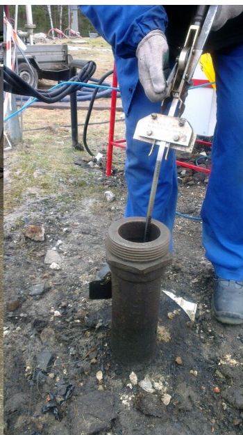
Pomiar wysokości napelnienia zbiorników za pomocą przyrządu wstęgowego
