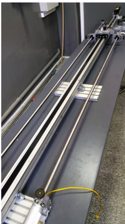
Wzorcowanie mierników do pomiaru wysokości napełnienia zbiorników
